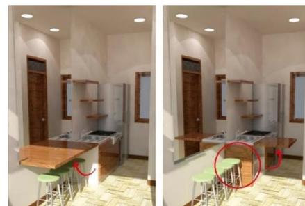
**Gambar 3.** Ilustrasi meja makan dan meja kabinet yang *foldable*; meja makan terbuka dan kabinet tertutup (kiri); meja makan terlipat dan kabinet terbuka (kanan)
