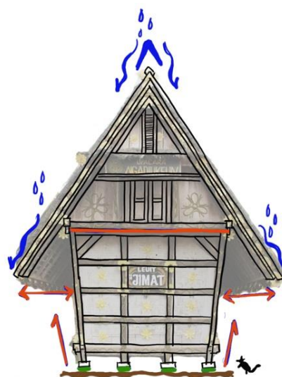
Gambar 8. Sudut Kemiringan Atap Leuit Yang Curam Membuat Air Hujan Mengalir Dengan Cepat
