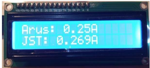
Gambar 12. Hasil pengukuran arus dengan JST
