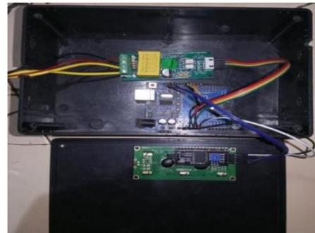
**Gambar 4.** Rangkaian Alat Ukur Sensor Arus
