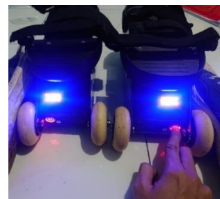
Gambar 12. tombol power yang terdapat pada sepatu roda untuk menyalakan dan mematikan
