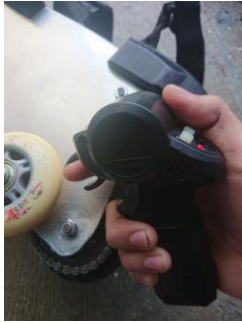
Gambar 15. Proses pengereman sepatu roda pengguna dapat menekan throttle ke atas
