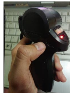
Gambar 11. tombol power pada Remote RC untuk menyalakan dan mematikan
