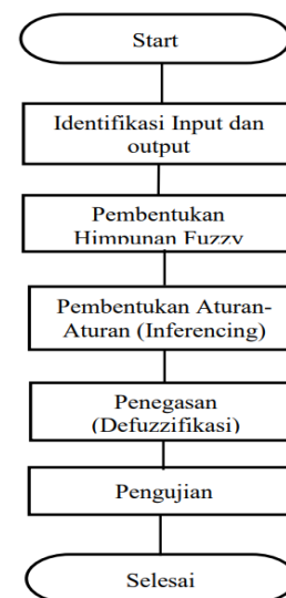
Gambar 1. Diagram Alir Simulasi Kontrol Kecepatan Kereta Api
