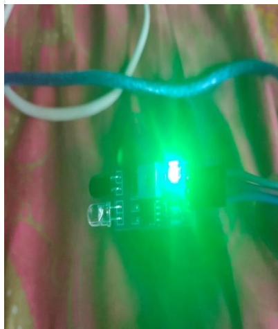
Gambar 15 Kondisi infrared tidak mendeteksi objek
