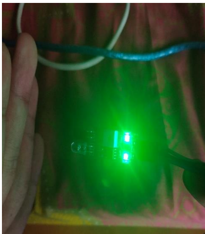
Gambar 14 Kondisi infrared mendeteksi adanya objek
