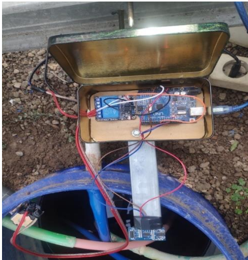
Gambar 11 implementasi perangkat keras wadah komponen tandon Greenhouse tampak atas
