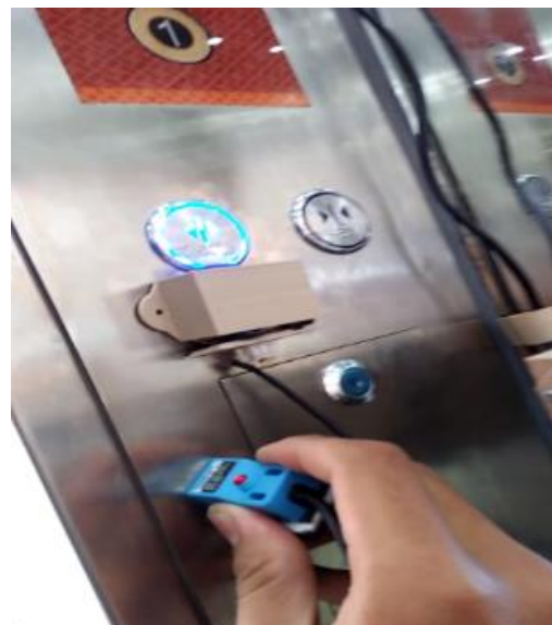
Gambar 7. Hasil Pengujian Motor Servo untuk Membuka Pintu Lift
