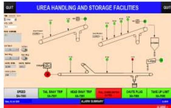
**Gambar 9.** Pengujian Indikator HMI pada *Line 3 Conveyor*
