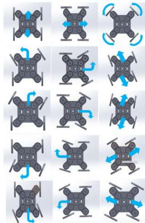
Gambar 8. Sketsa sistem kemudi robot.
