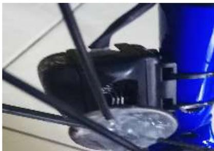
Gambar 14. Keadaan ON dari Sensor Magnet
