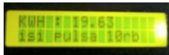
Gambar 6. Tampilan Layar LCD saat Pengisian Voucher Pulsa saat Kode yang Dimasukan Benar ( Valid ) atau Berhasil
