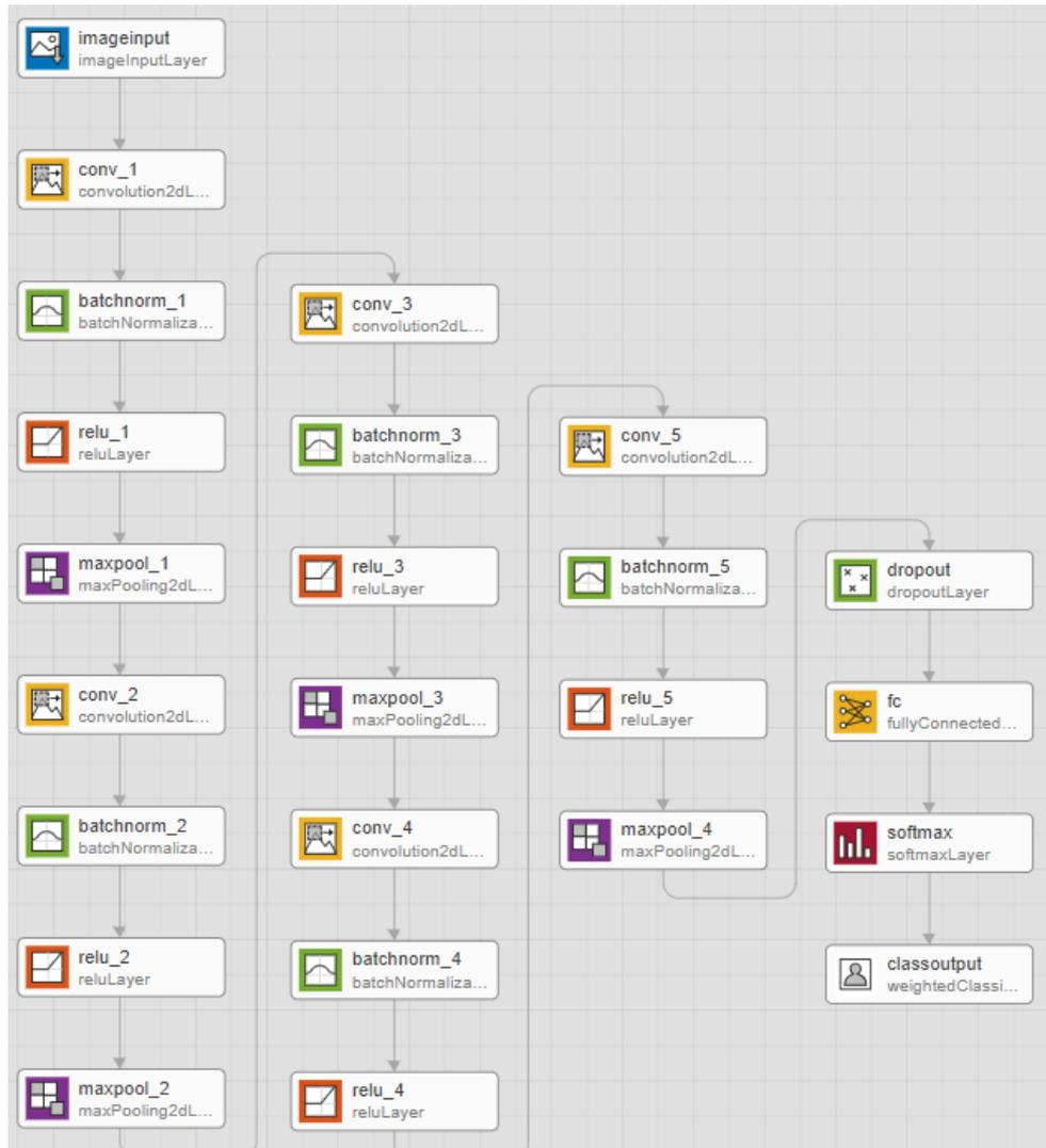
Gambar 4 Diagram Blok Arsitektur CNN
