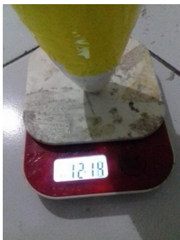
Gambar 8 Pengujian Daya Dorong
