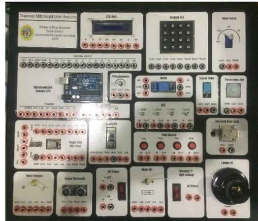
**Gambar 2** Trainer Mikrokontroler Arduino Uno
