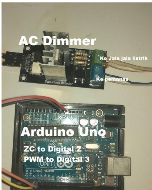
Gambar 15. Wiring dari Arduino ke Modul AC Dimmer
