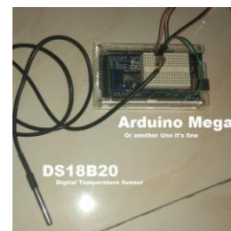
Gambar 5. Wiring dari pembacaan suhu
