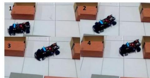
Gambar 18. Mobil Mundur Melakukan Manuver Masuk Ke Dalam Ruang Parkir sisi kanan
