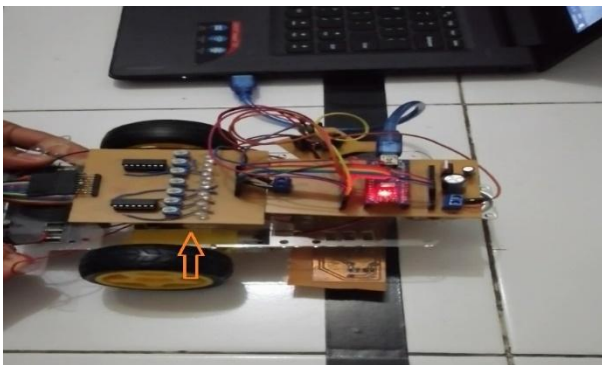
Gambar 19. Sensor mengenai lintasan
