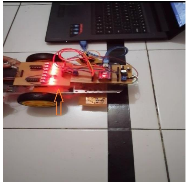
Gambar 20. Sensor tidak mengenai lintasan
