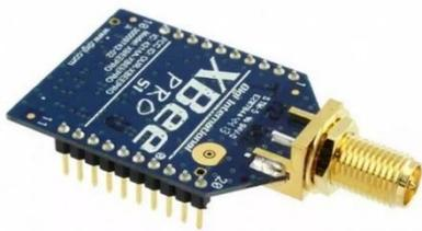
**Gambar 7** Radio komunikasi XBEE Pro 2.4 GHz
