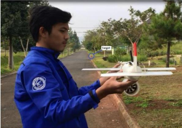
Gambar 16 Uji darat sistem navigasi
