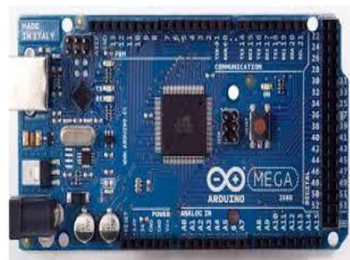
Gambar 21. Gambar arduino mega rev3
