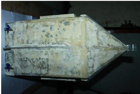
**Gambar 12.** Tampak bawah proses pendempulan
