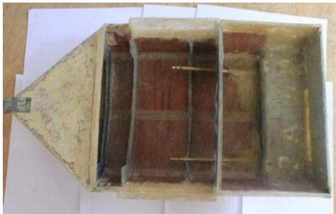
**Gambar 13.** Tampak atas proses pendempulan
