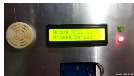
Gambar 14. Kondisi tag yang digunakan berbeda
