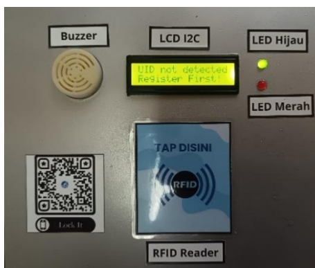
Gambar 12. Kondisi saat tag RFID belum terdaftar
