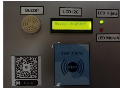
Gambar 13. Kondisi saat tag RFID dapat mengakses
