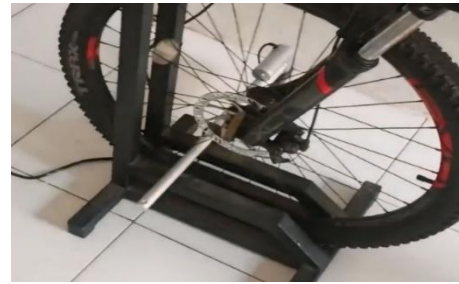
Gambar 17. Keadaan Linear Actuator saat mengunci
