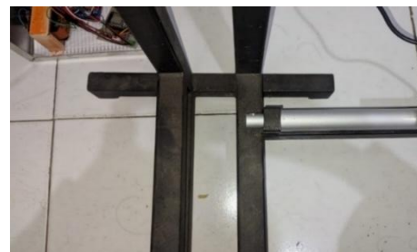
Gambar 19. Keadaan saat Linear Actuator terbuka
