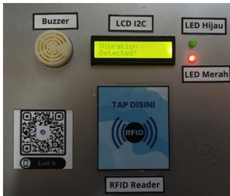
Gambar 15. Pesan pada LCD saat terjadi getaran
