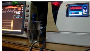
**Gambar 13.** Pengujian dan perbandingan alat yang sudah dibuat dengan alat medis (1)
