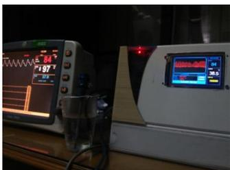
**Gambar 16.** Pengujian dan perbandingan alat yang sudah dibuat dengan alat medis (4)
