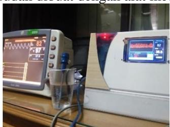
**Gambar 18.** Pengujian dan perbandingan alat yang sudah dibuat dengan alat medis (6)
