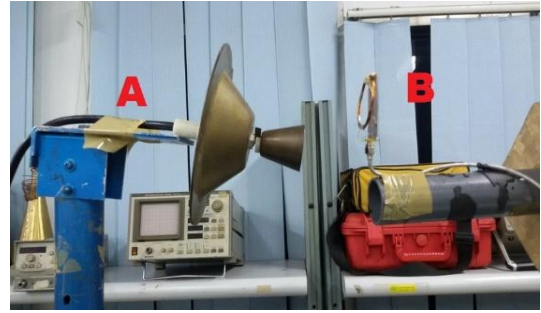
Gambar 18. Konfigurasi Pengukuran Gain (a. antenna referensi, b. antenna uji)
