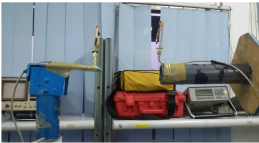
Gambar 16. Skema Pengukuran Pola Radiasi
