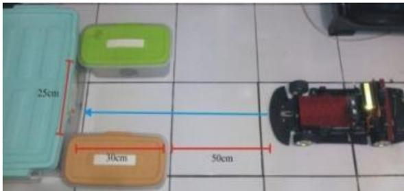
Gambar 24. Titik Awal Prototype Mobil Masuk Daerah Sempit Dengan Posisi sejajar
