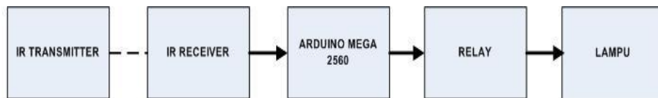
Gambar 8 Blok diagram pengontrolan lampu dengan IR
