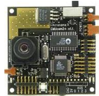
Gambar 9. CMUCam 2 sebagai sensor kamera
