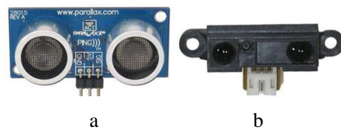
Gambar 10. Sensor jarak a. Sensor ultrasonik, b. Sensor Infra Merah
