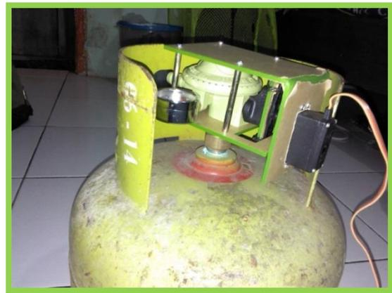
**Gambar 16.** Regulator Gas dengan Mekanik yang sudah Terpasang
