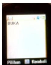
Gambar 13 Tampilan SMS Perintah Untuk Membuka Pintu
