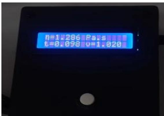
**Gambar 7.** Contoh tampilan pada *display* purwarupa setelah pengujian
