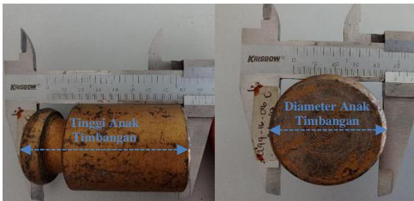
**Gambar 9.** Pengukuran tinggi dan diameter anak timbangan 1 kg menggunakan *caliper*
