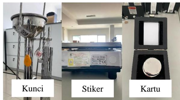
Gambar 7. Penempatan tag pada tiap UTTP.
