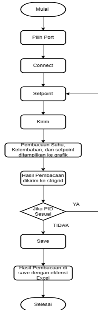
Gambar 6. Flowchart Diagram Aplikasi Monitoring oven menggunakan delphi 7
