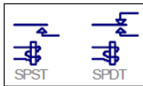
Gambar 4. Konfigurasi Relay SPST dan SPDT
