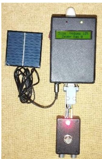
Gambar 8. Hasil akhir alat peringatan volume septic tank dan netralisasi kadar sewer gas
