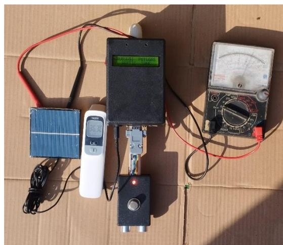
Gambar 10. Pengujian Sistem charge baterai dengan panel surya
