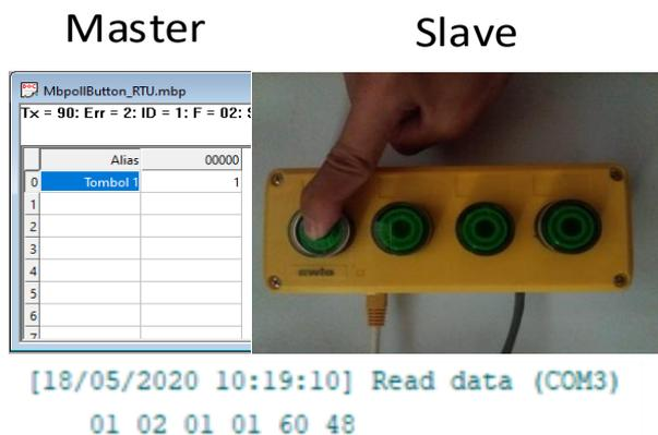
Gambar 6. Pengujian Single Read Modbus RTU
