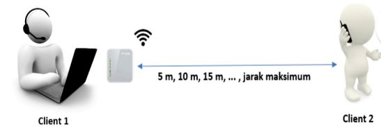
Gambar 6 Ilustrasi pengujian jarak coverage maksimum router
