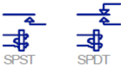
Gambar 6. Konfigurasi Relay SPST dan Relay SPDT
