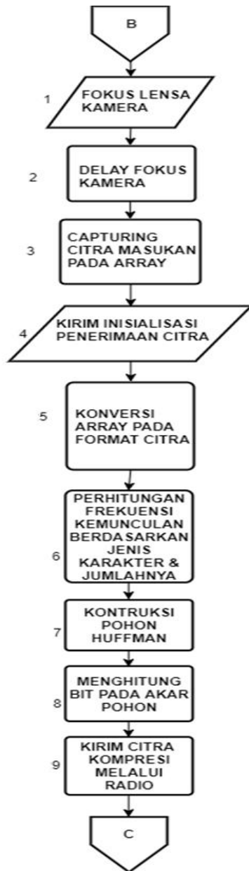
Gambar 7. Bagian diagram alir pengiriman gambar
