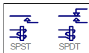
Gambar 2. Konfigurasi Relay SPST dan Relay SPDT
