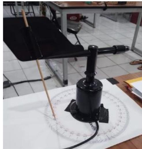
Gambar 15. Pengujian sensor arah angin
