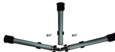
Gambar 3.5. Arah Gerak Teleskop Sumbu-X (Teleskop Tampak Dari Atas)
