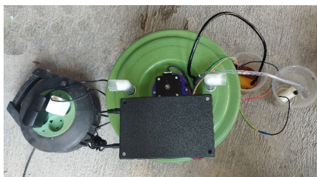
Gambar 7. Pengujian Keseluruhan Sistem Pengolah Limbah Rumah Tangga menjadi Kompos berbasis Mikrokontroler
