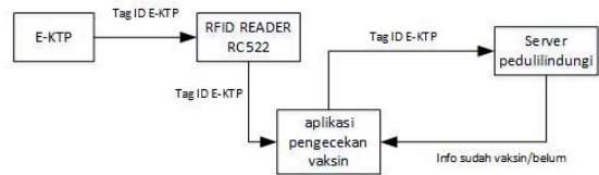
Gambar 3 Prinsip kerja sistem
