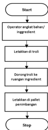
Gambar 5. Alur proses mengangkat bahan kemasan 25 kg
