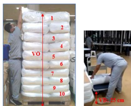
Gambar 8. Memindahkan Ingredient Kemasan 25 kg Dari Pallet ke Troli
