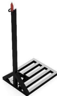
Gambar 3. Kerangka pengupas sabut kelapa
