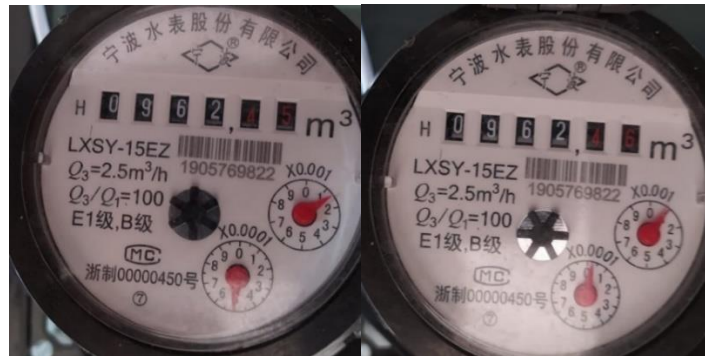
Gambar 8. Meteran air sebelum dan sesudah dilewati air
