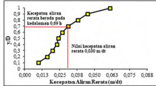
**Gambar 44.** Grafik Hubungan Antara Kecepatan Aliran Rerata Dengan Kedalaman B/8 Kiri
