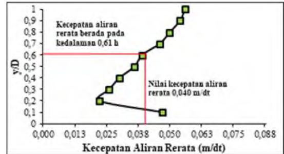
**Gambar 24.** Grafik Hubungan Antara Kecepatan Aliran Rerata Dengan Kedalaman B/16 Kanan
