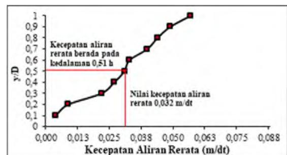
**Gambar 18.** Grafik Hubungan Antara Kecepatan Aliran Rerata Dengan Kedalaman B/2 Tengah
