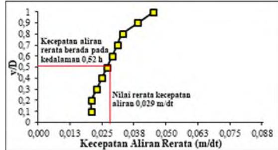
**Gambar 20.** Grafik Hubungan Antara Kecepatan Aliran Rerata Dengan Kedalaman B/8 Kiri
