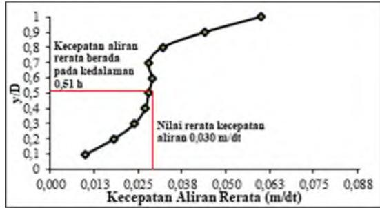
**Gambar 19.** Grafik Hubungan Antara Kecepatan Aliran Rerata Dengan Kedalaman B/4 Kiri
