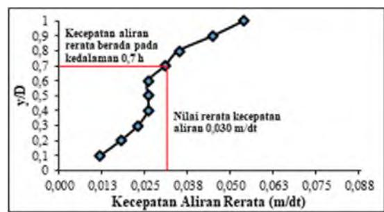
**Gambar 22.** Grafik Hubungan Antara Kecepatan Aliran Rerata Dengan Kedalaman B/4 Kanan
