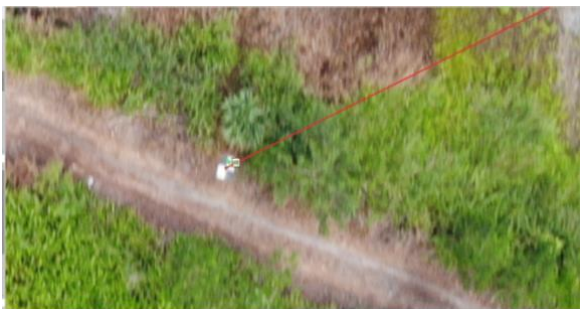
Gambar 16. Premark atau GCP yang difoto menggunakan drone
